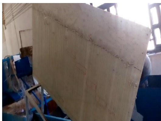
شکل ۲ تابلو نصب پیزومترها با چرخش ۳۰ درجه
