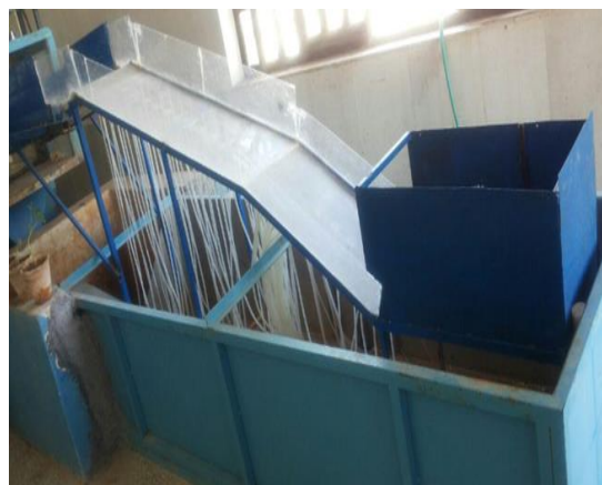
شکل ۳ تصویر مدل فیزیکی سرریز سد سورک
